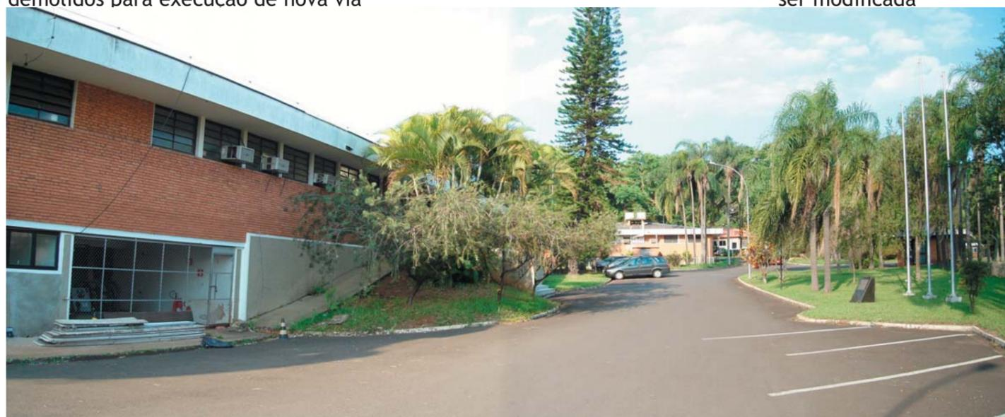
208 e 207-À esquerda pavimento a demolir junto ao Lab. de Biotecnologia Vegetal I para execução de jardim e calçada. À direita guia a ser modificada
