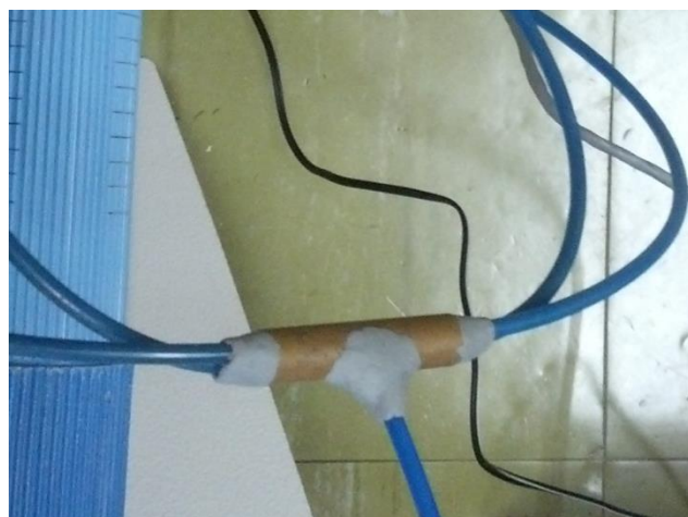
Foto 4: Idem anterior – detalhe da equalização das tomadas de pressão.
