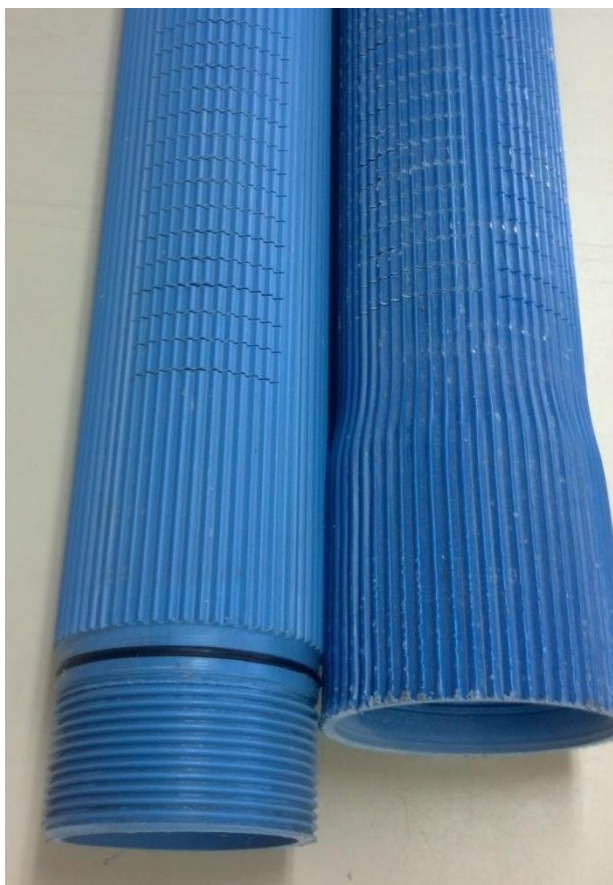
Foto 1: Vista das extremidades dos tubos ranhurados, tipo ponta-e-bolsa, com acoplamento por rosca, diâmetro interno aproximado de 50 mm.
