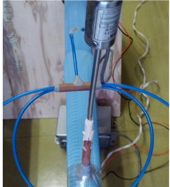
Foto 6: Idem anterior – com o anemômetro inserido e alinhado.
