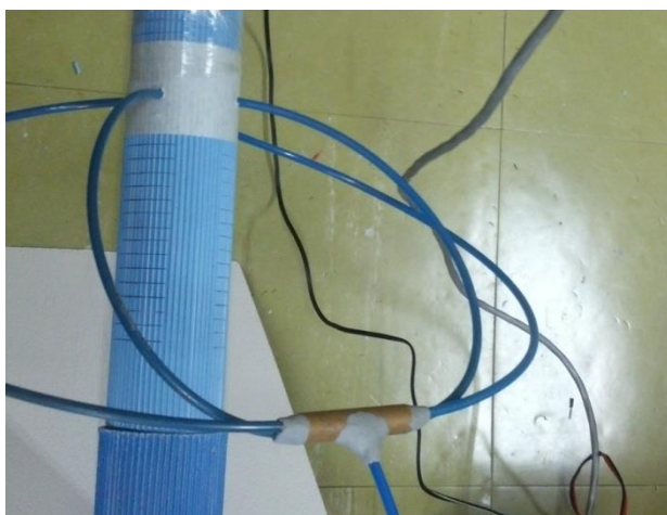
Foto 3: Detalhe dos quatro pontos de tomada de pressão por seção transversal.
