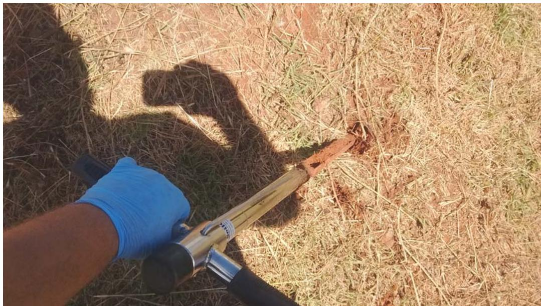
**Foto 3 –** Procedimento de Amostragem de uma alíquota a trado manual de coleta
