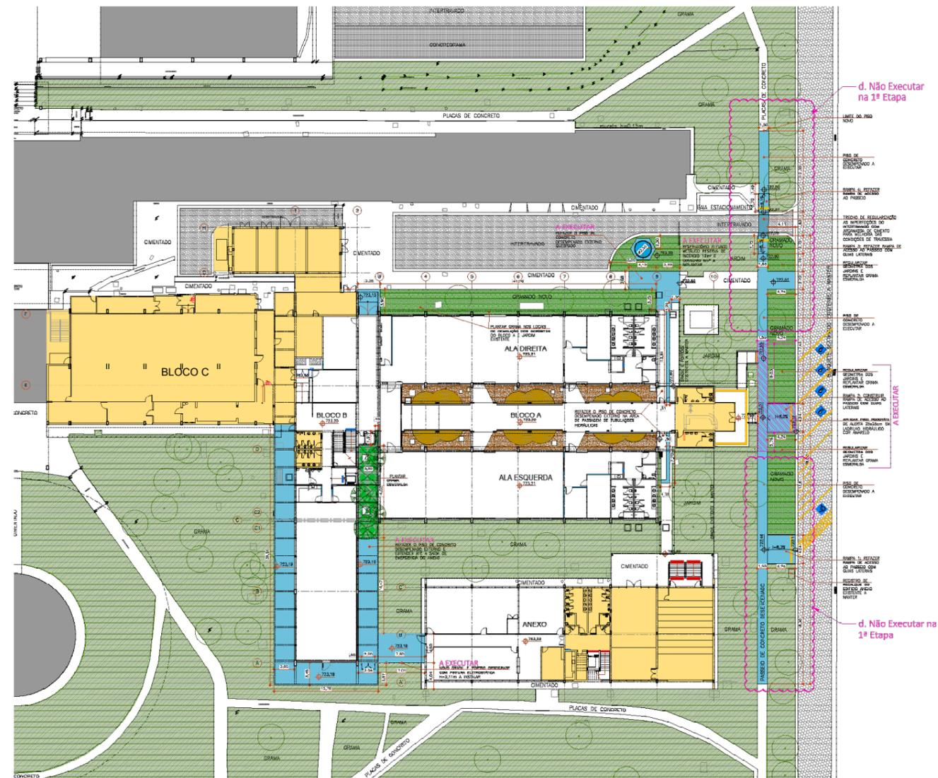
Planta baixa do térreo do conjunto: edifício Anexo [embaixo, à direita] e Blocos A, B e C [da direita para a esquerda no centro]
