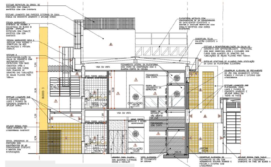
Corte atravessando a plataforma elevatória e os sanitários acessíveis
