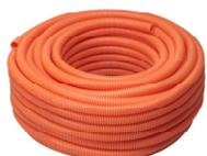
Eletroduto de Policloreto de Vinila (para uso opcional em instalações de energia em pisos), antichama, na cor laranja, de seção circular, com corrugado helicoidal, impermeável, resistência à compressão ~ 750N / 5cm. Fabricado e ensaiado conforme Norma: NBR 15.465.
