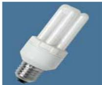
5.18.4 - Lâmpada Fluorescente Compacta (T4) 23 W, com reator de 220V integrado à Base (E27) - IRC  $\geq$  0.8, Fluxo luminoso  $\geq$  1.600 lm, temperatura de cor  $\geq$  4.000<sup>º</sup> K, vida média  $\geq$  8.000 horas.
