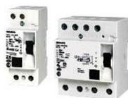
Termomagnéticos do Tipo DR, unipolares ou multipolares, com acionamento por alavanca, com correntes e capacidades de interrupção especificadas no projeto, conforme norma internacional EC 61008-2-1. Correntes nominais: 25, 40, 63, 80, 100 e 125A. Sensibilidade a corrente nominal residual de 30mA, para proteção pessoal, de materiais, contra incêndios e contato direto com componentes ativos. Sensibilidade a corrente residual nominal de 300mA para proteção contra incêndio, contatos indiretos.
