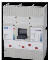
5.14.3 - Disjuntor em Caixa Moldada de 250A a 800A - disjuntor termomagnético, capacidade de ruptura de 65kA (em 230V) ou de acordo com lcc do projeto. Devem ter os disparos térmicos e magnéticos ajustáveis. Fixação por parafusos ou trilhos, temperatura de operação de -25°C a 70°C. Devem ter certificação do INMETRO.
