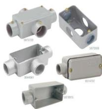
Condulete de Alumínio (uso obrigatório p/ instalações de lógica e opcional p/ instalações de energia) - construído em liga de alumínio de alta resistência mecânica e à corrosão, isentos de qualquer rebarba, tampa aparafusável no mesmo material da caixa e guarnição de borracha para vedação. Acabamento alumínio natural polido ou em pintura epóxi na cor cinza. Para instalações externas, as entradas devem ter roscas do tipo BSP
