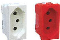
5.22.1 - Tomada em formato de poço sextavada do tipo 2P + T (2 polos e terra), sem placa de acabamento, nas cores branca 127 V / 20A ou vermelha 220 V / 20A, para montagem em módulos embutidos, fabricada em material termoplástico auto extingüível, em poliamida 6.6 ou melhor, com tensão de isolamento de 250V, contatos em latão, terminais de ligação embutidos, devem estar de acordo com a norma NBR-14136 e conforme a Portarias INMETRO nº 185 de 2000, e nº 038, de 26
