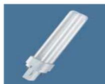
5.18.5 - Lâmpada Fluorescente Compacta 26 W, Base – GX24d-3 - IRC  $\geq$  0.8, Fluxo luminoso  $\geq$  1.600 lm, temperatura de cor  $\geq$  4.000<sup>º</sup> K, vida média  $\geq$  6000 horas.
