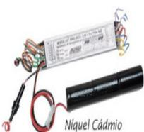
5.20.1 - Módulo Autônomo de emergência (embutido na própria luminária) para 1 lâmpada fluorescente compacta bipino até 42V. Com bateria de Níquel-Cádmio 12V x 7Ah, autonomia  $\geq$  1h, alimentação de 220V.
