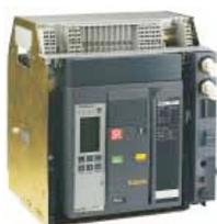
5.14.4 - Disjuntor em Caixa Aberta acima de 800A - disjuntor termomagnético, capacidade de ruptura de **65KA** (em 230V) ou de acordo com lcc de projeto. Devem ter os disparos térmicos e magnéticos ajustáveis. Fixação por parafusos, temperatura de operação de -25°C a 70°C. Devem ter certificação do INMETRO.
