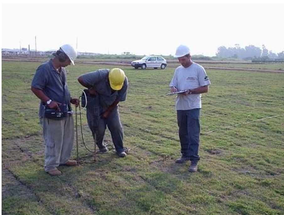
Foto 05 Soil Gas Survey medida com detector de gás
