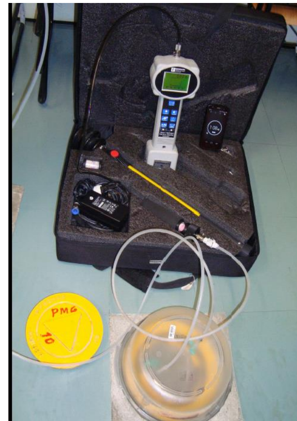
Teste de estanqueidade em poço de monitoramento de gás – PMG-10.
