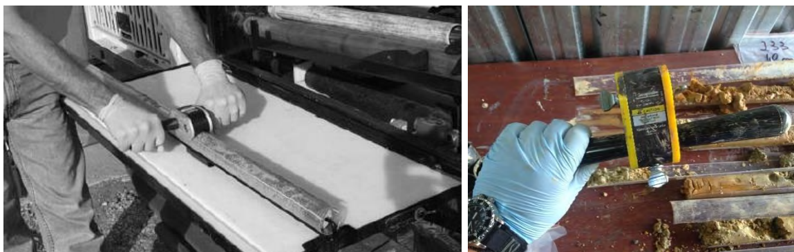
Figura 10 – Cortador de Liners utilizado e método de corte.
