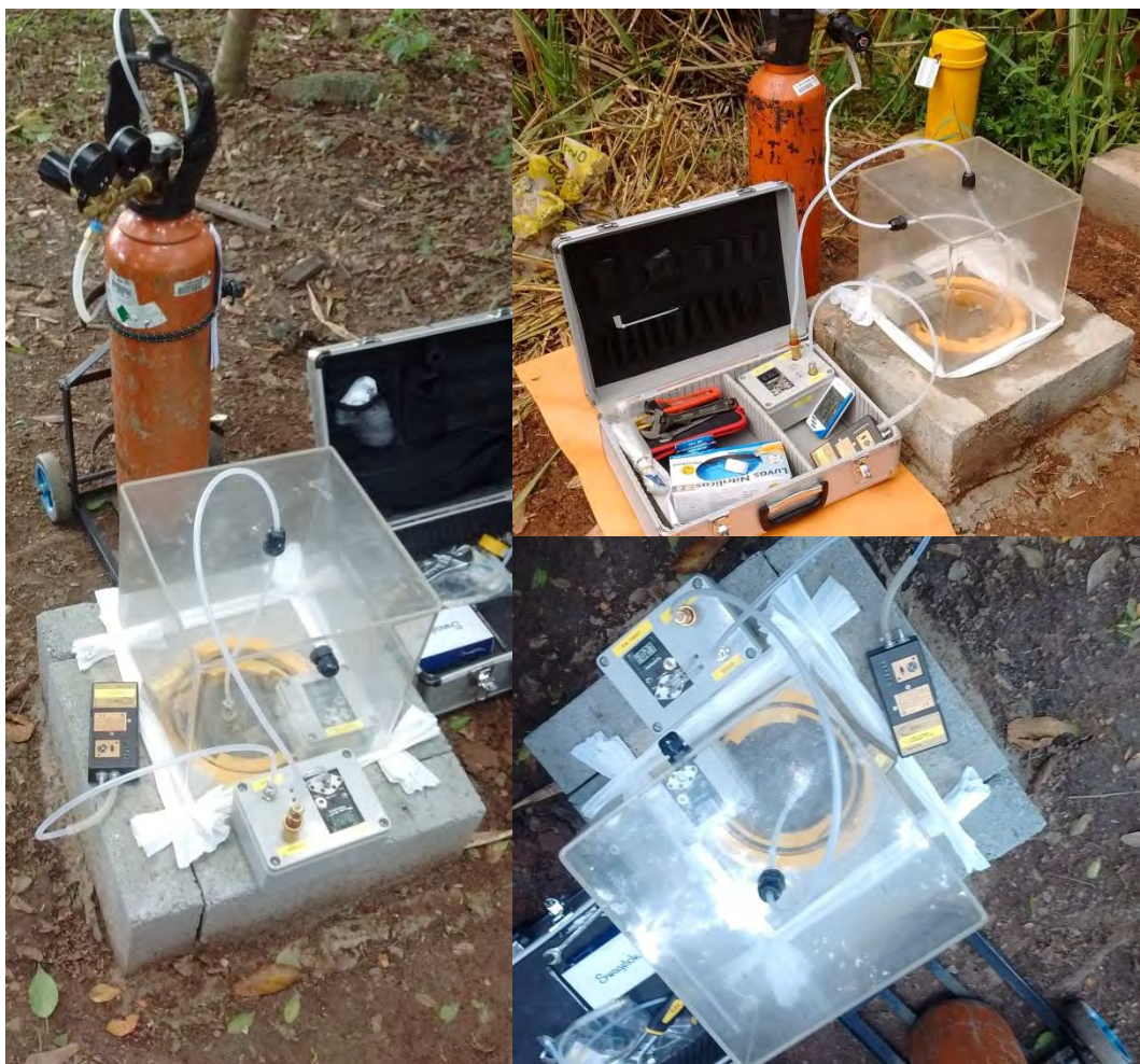
Figura 20 – Teste de estanqueidade – Poços de Monitoramento de Gases
