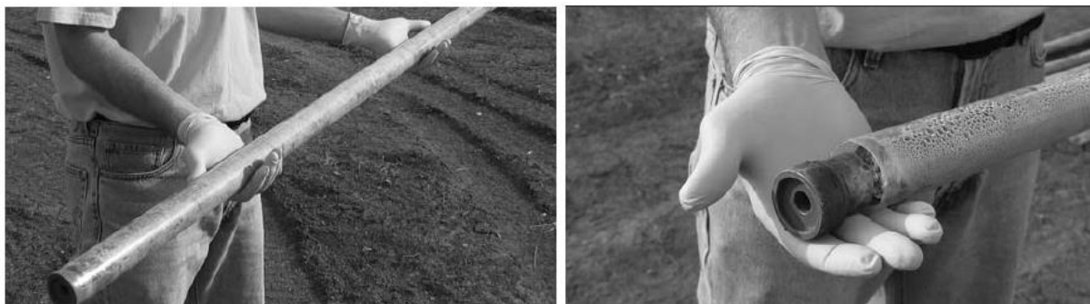
Figura 9 – Liner contendo amostra de solo e retirada da ponteira.
