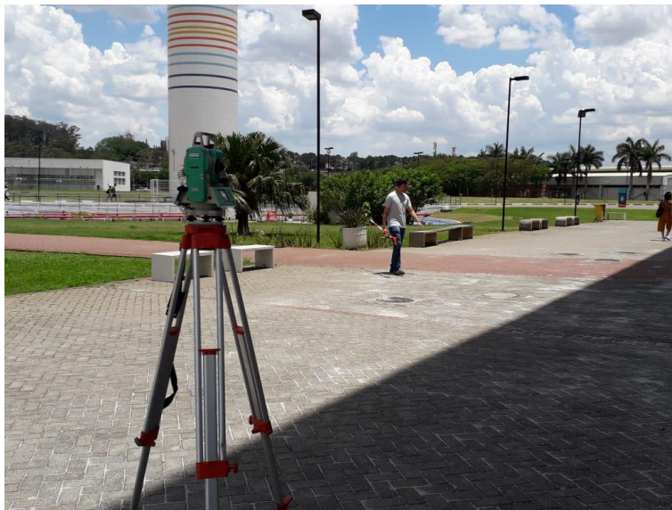
Foto 14 – Levantamento topográfico com Estação Total
