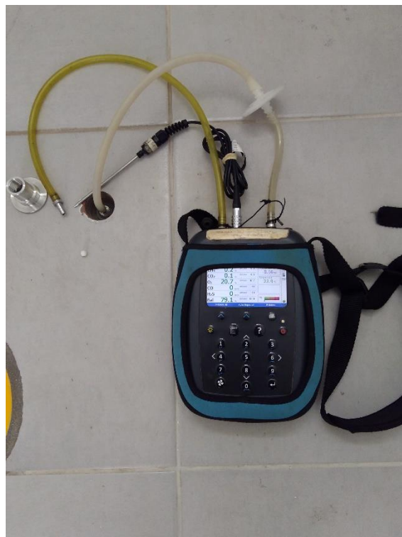
Foto 12 – Medição de metano no poço de monitoramento de gases no contrapiso ( subslab )
