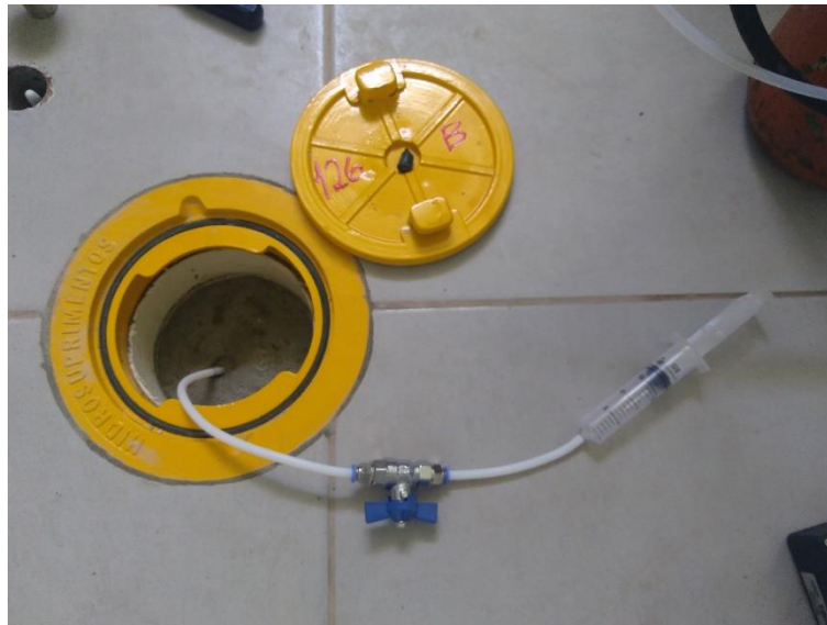
Foto 01 – Purga do volume de vapores estagnados no interior de cada ponto de amostragem
