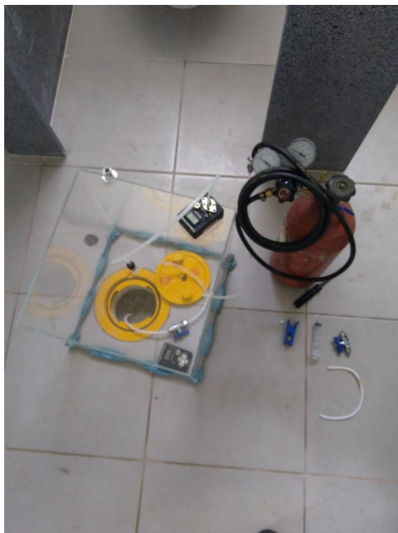
Foto 02 – Teste de estanqueidade nos poços de monitoramento de gases
