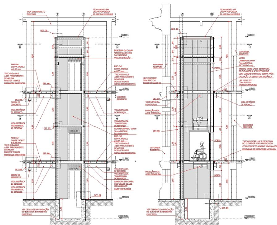
Cortes do elevador a ser instalado
