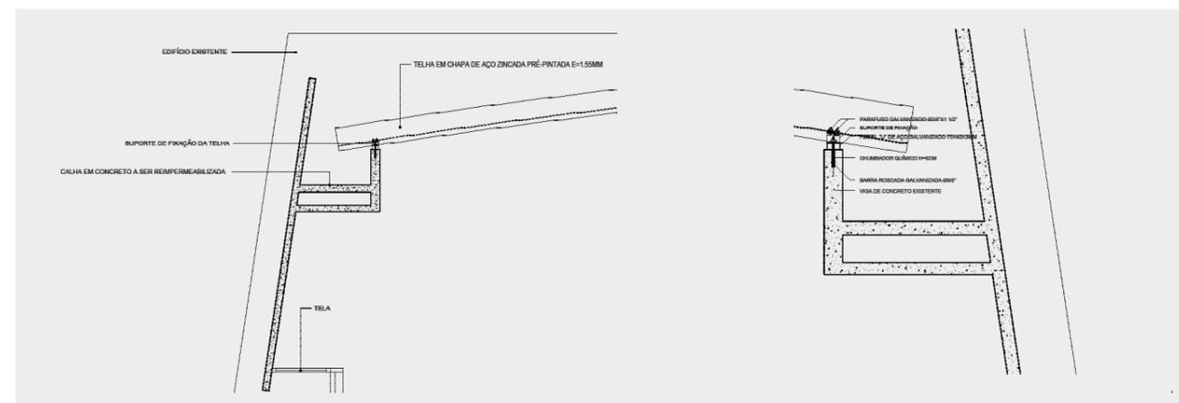
Detalhe da calha e detalhe da fixação das telhas
