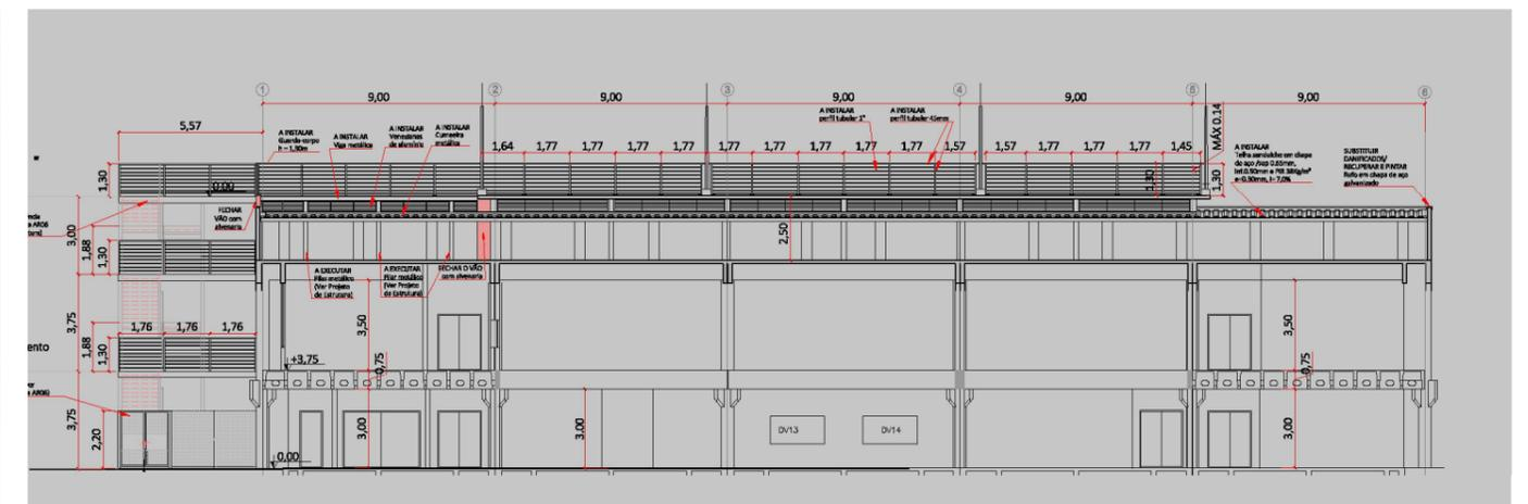
Corte transversal com a escada de emergência, a passarela de emergência e os guarda-corpos
