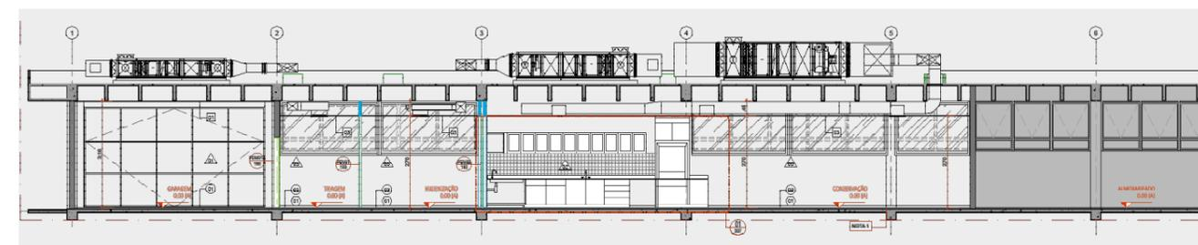
Corte atravessando a área dos laboratórios e mostrando os equipamentos sobre a laje de cobertura
