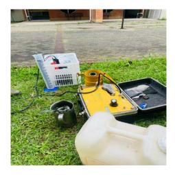
Foto 5 – Realização de amostragem de água no poço de monitoramento localizado na área externa do Campus (PM-11).
