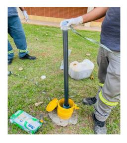
Foto 3 – Realização da Purga no poço de monitoramento localizado na área externa do Campus (PM-18).
