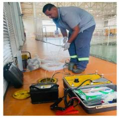
Foto 6 – Realização de amostragem de água no poço de monitoramento localizado dentro do cemitério (PM-22).
