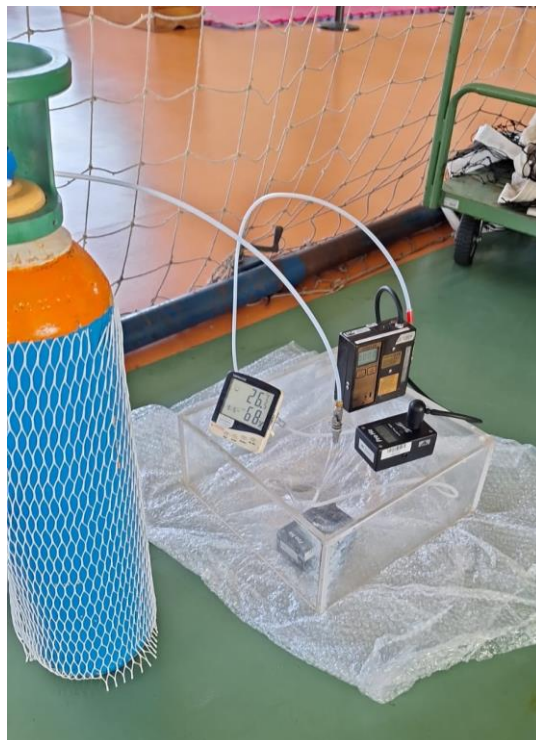
Fotografia 12. Teste de Estanqueidade – 4ª Fase.
