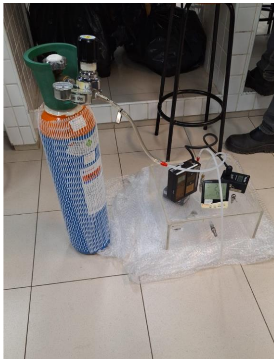
Fotografia 8. Teste de Estanqueidade – 3ª Fase.
