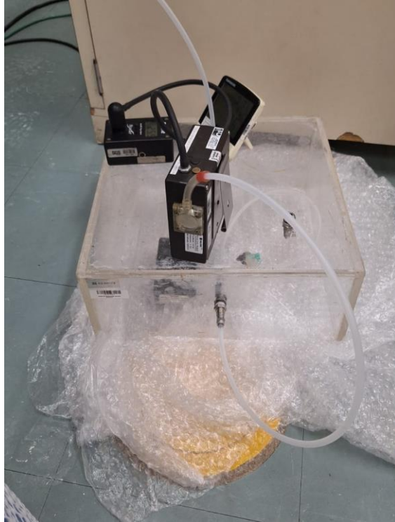
Fotografia 5. Teste de Estanqueidade no PMG-03B – 2ª Fase.
