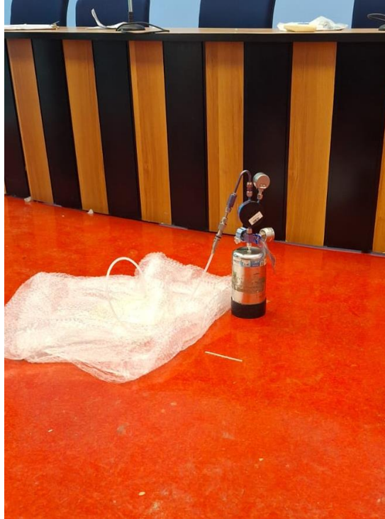
Fotografia 9. Teste de Estanqueidade – 3ª Fase.
