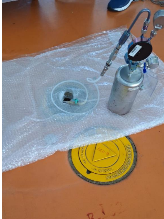
Fotografia 13. Amostragem de Gases – 4ª Fase.
