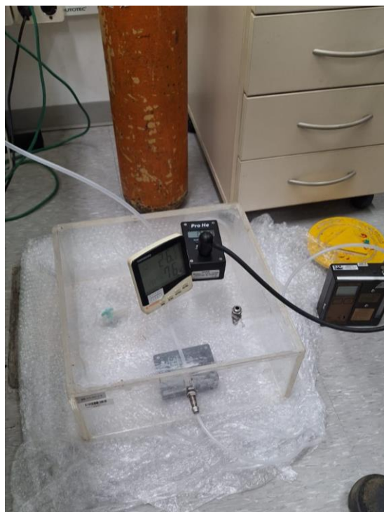
Fotografia 2. Teste de Estanqueidade no PMG-16B – 1ª Fase.
