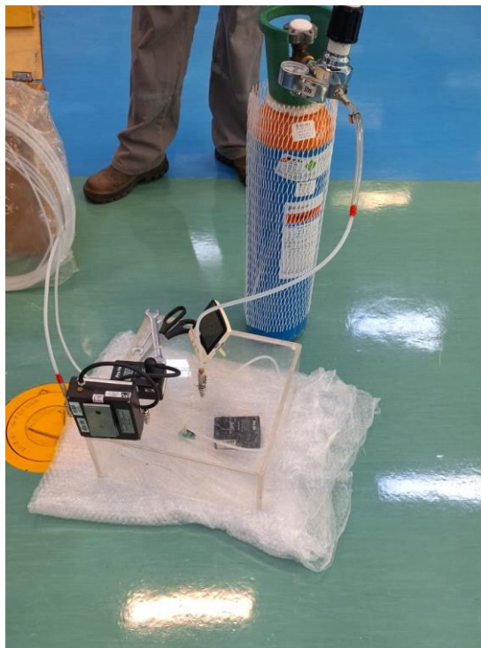
Fotografia 10. Teste de Estanqueidade – 3ª Fase.
